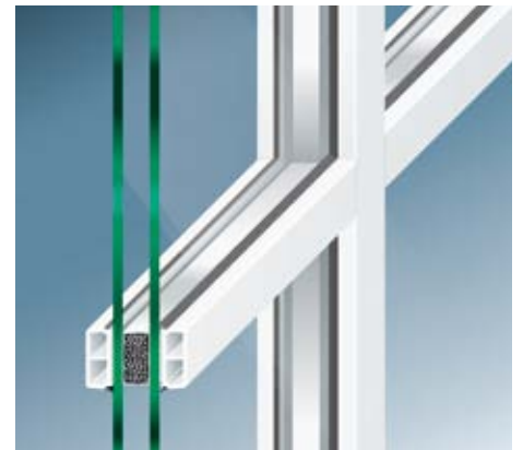
Aufgesetzte Ziersprosse mit zusätzlichem Abstandhalter im Glas (Bei 3-fach-Isolierglas in einem bzw. in beiden Luftzwischenräumen ausführbar)
